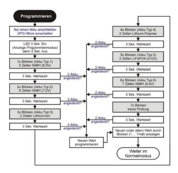
Eine Alternativ-Programmierung des **DualBat-**Systems bzw. die Programmierung des **SingleBat-**Systems ist über den Spannungswahlschalter gemäß Beschreibung möglich. Da beim **SingleBat-**System nur <u>ein</u> Akku verwendet wird, funktioniert die Programmierung nur mit dem Spannungswahlschalter!
