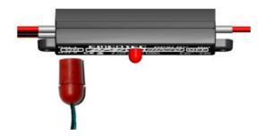
Für den Fall, dass beim **DPSI Micro - DualBat** ein Akku nicht angesteckt sein sollte, oder ein Akku defekt ist, startet das **DPSI** im Programmiermodus. Dieser Programmiermodus wird automatisch nach ca. 30 Sekunden verlassen. Innerhalb dieser ca. 30 Sekunden darf dann der fehlende Akku nicht angesteckt werden, wenn eine Neuprogrammierung des Akkutyps unerwünscht ist.
